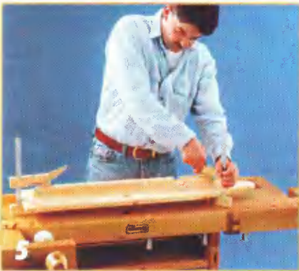
Снизу к гладильной доске крепят на шкантах с клеем несущий брусок 2, с которым шарнирно соединяют ножки складывающейся опоры.
