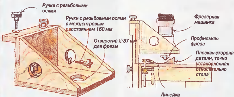
Навесная каретка служит для крепления фрезерной машинки при обработке деталей, лежащих плоской стороной на столе.
