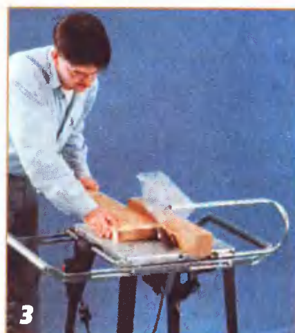
Детали складывающейся опоры стола вырезают из сосновых брусков сечением 40x25 мм.
