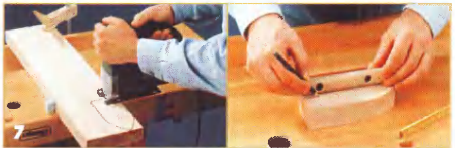
Вырезав из подходящей доски основание утюжка, к нему на шкантах приклеивают ручку — деревянный стержень Ø25 мм.
